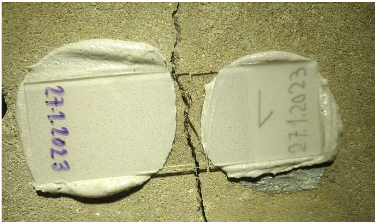
Obr. P-2: Prasklá skleněná destička na trhlíně s tahem a smykem
