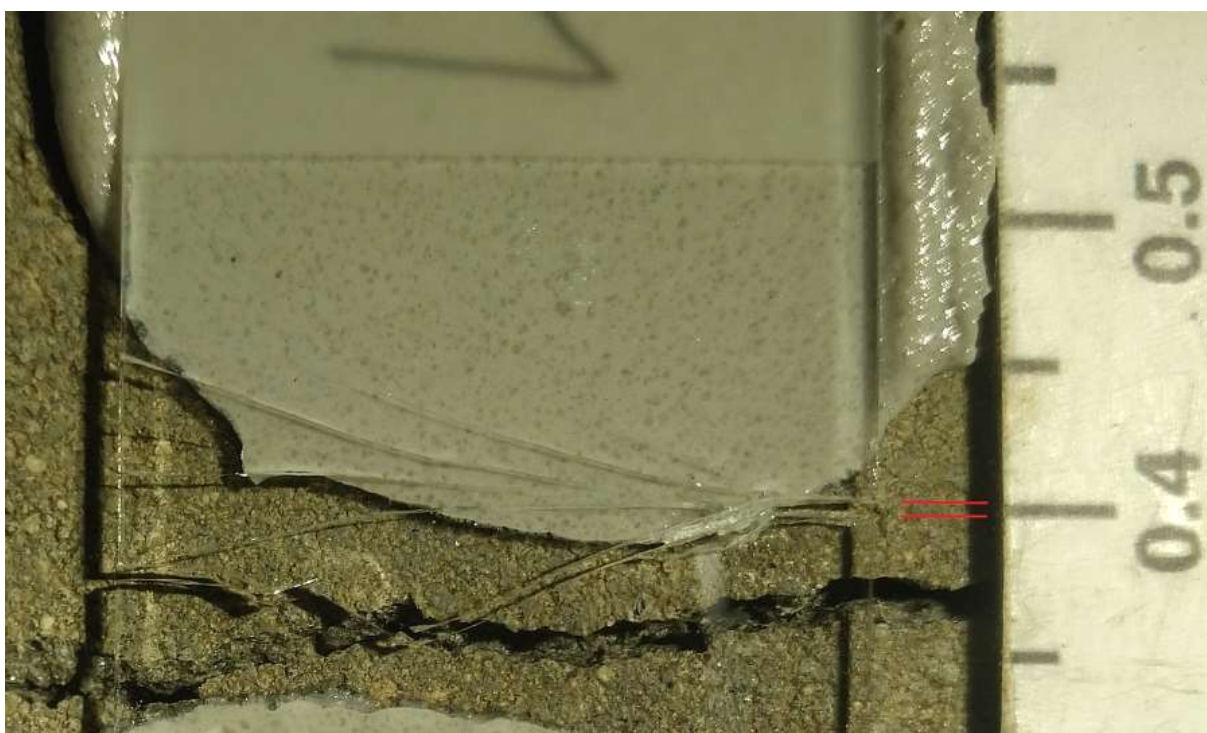
Obr. P-6: Detail porušení skla destičky při kombinaci tahu a smyku v trhlině – možnost přesného odečtení šířky trhliny zůstává
