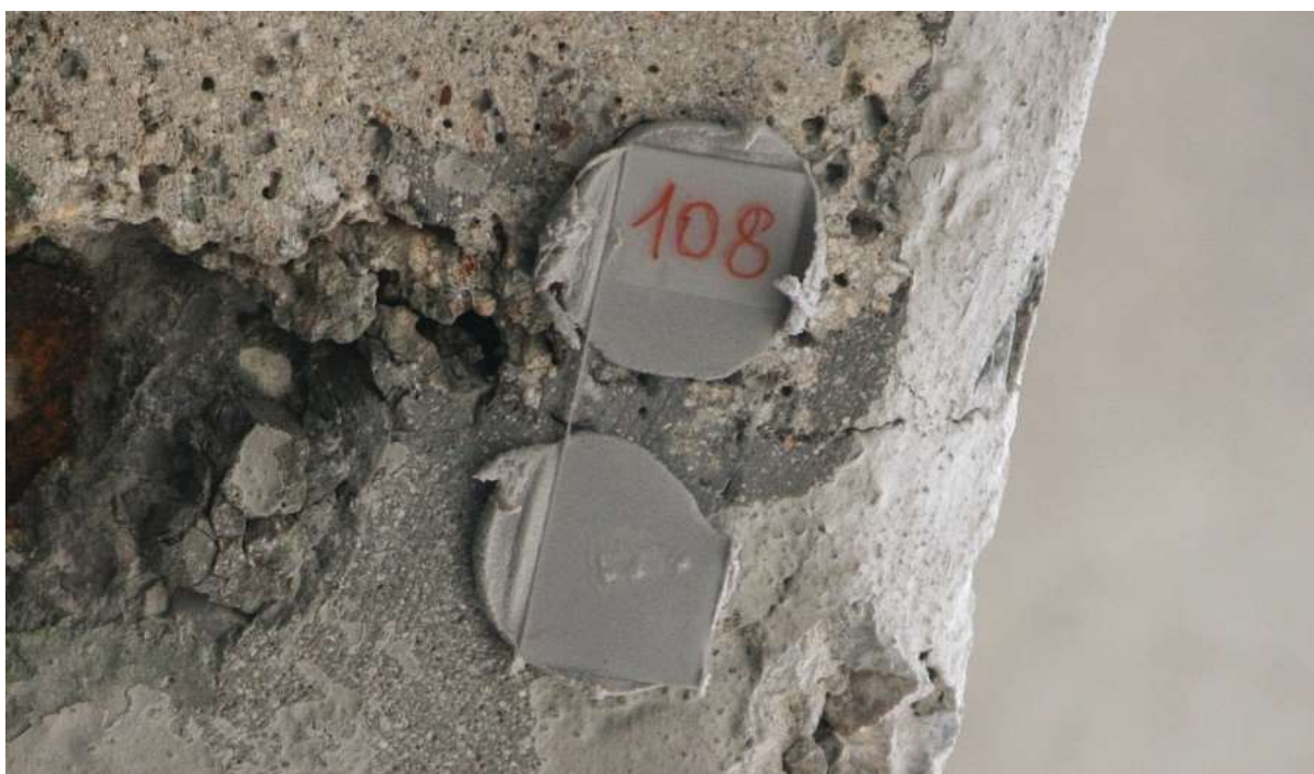
Obr. P-4: Skleněná destička nalepená v místě kontaktní spáry prefa nosníku (místo budoucí trhliny)
