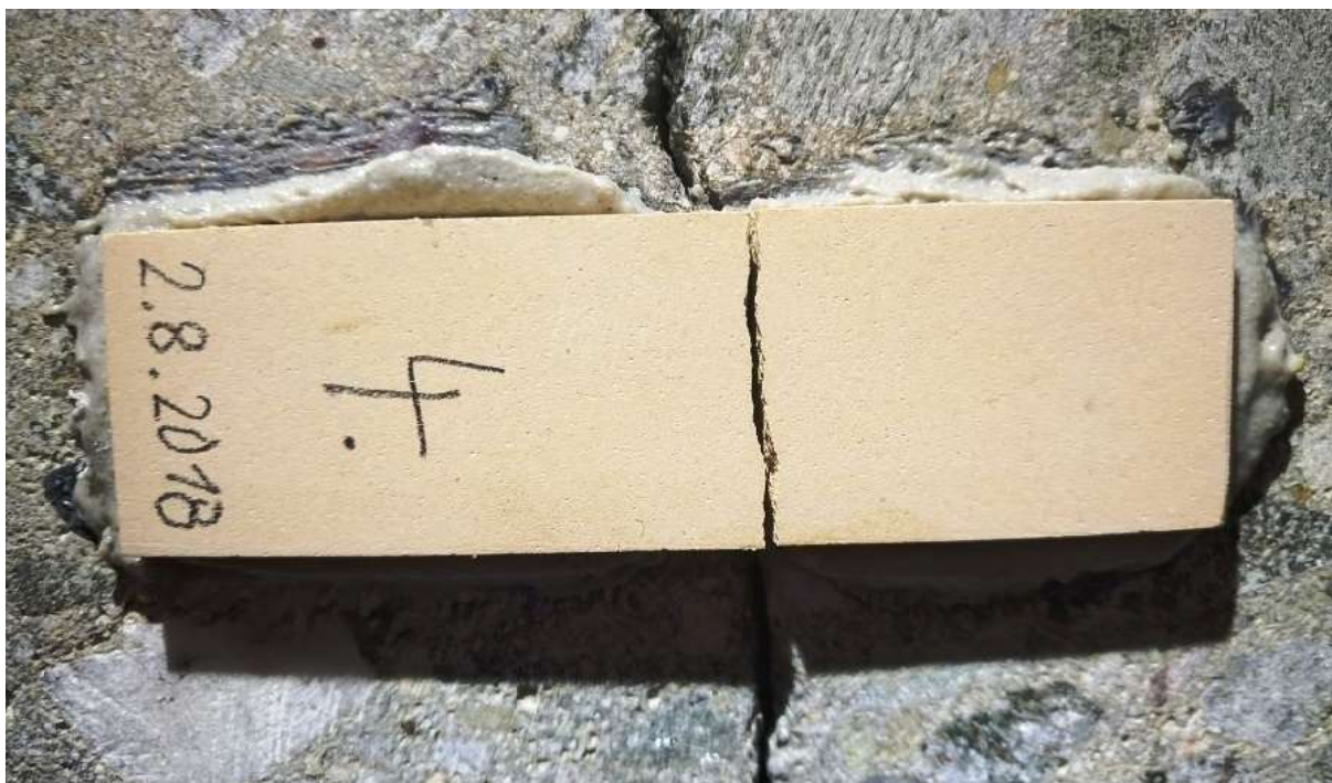
Obr. P-3: Prasklá keramická destička
